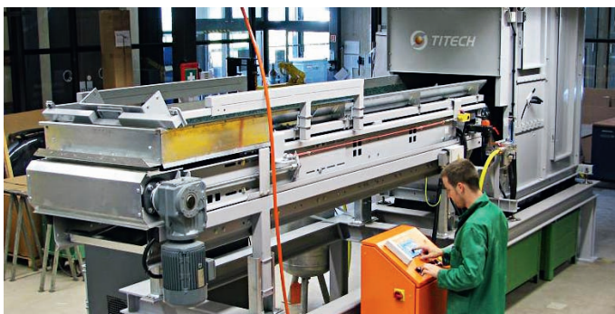
Abb. 1: Der Sensorsortierer im Umtec-Labor.
