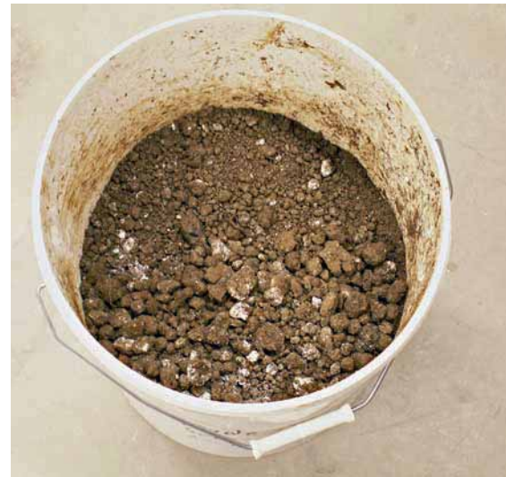
Abb. 5: Das mit Löschkalk in einem Eimer konditionierte Bodenmaterial zerfällt in eine krümelige Struktur.
