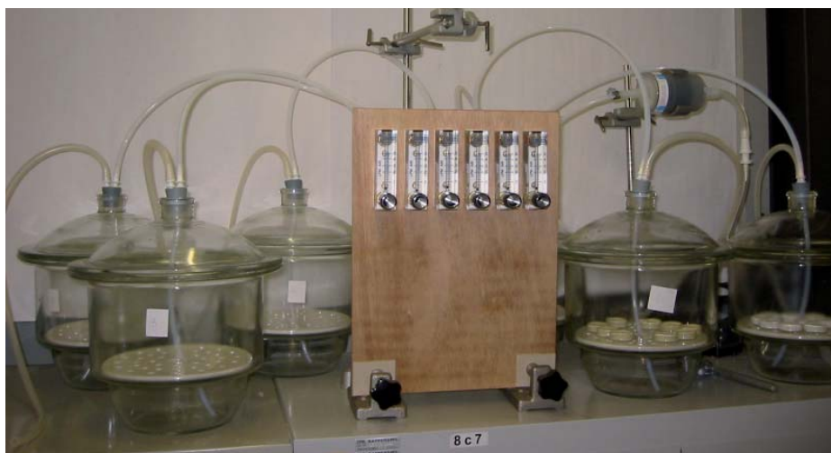
Abbildung 2: Emissionskammern (Exsikkatoren) mit den Proben «Fensterkitt» und «Silikon».
