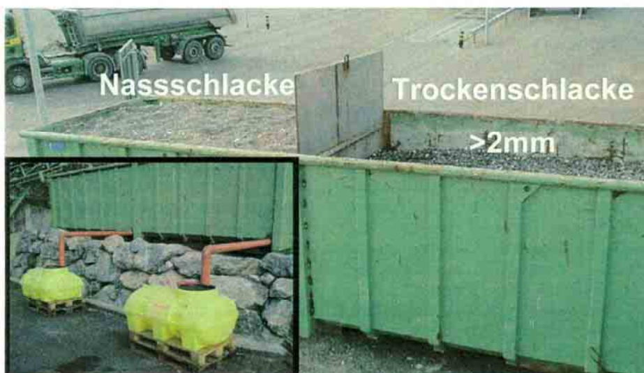
Beurteilung der Sickerwasserqualität durch einen «Muldenversuch».
