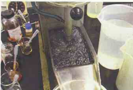
Abb. 1 zeigt die russbeladene Schaumschicht (Laborflotationsszelle/Demonstrationsanlage).
