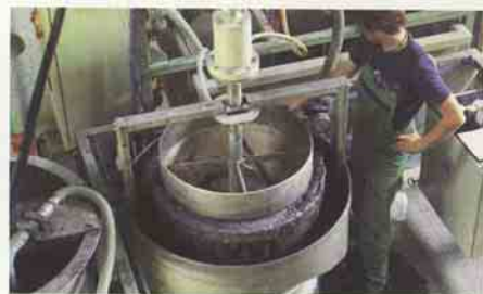
Abb. 3: Flotation in der Demonstrationsanlage.
