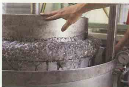
Abb. 1 zeigt die russbeladene Schaumschicht (Laborflotationsszelle/Demonstrationsanlage).
