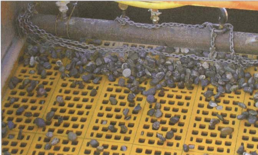
Abbildung 2: Anstauen des Kieses unter der Druckluftleiste mittels Ketten
