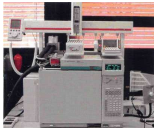
Abb. 4 Gas-Chromatograph mit den zwei Detektoren FID und ODR
