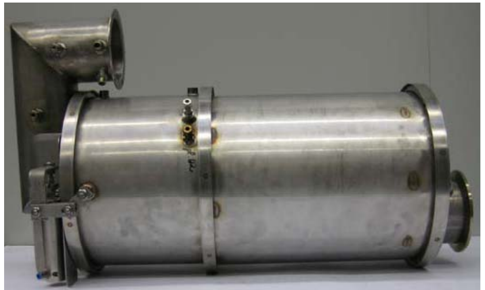
Abb. 1: NO 2 -optimiertes Partikelfiltersystem NO x OPT
