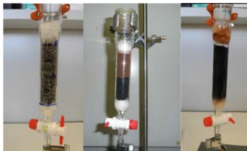
Abb. 1: Einzelne Adsorbentmaterialien sowie Materialkombinationen im Laborversuch (Sorptionsversuch in Kolonnen).
