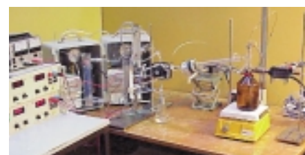
Laboranlage für die NO x -Reduktion bei Dieselmotoren
