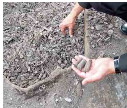
Intakte Batterien in der Feinschrottfraction aus einer Kehrichtverbrennungsanlage (Photo: Martin K. Meyer/GSA)
