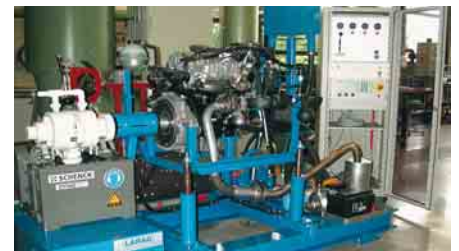
Der HSR-Motorprüfstand im Aufbau
