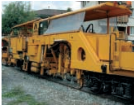
Gleisbaumaschine ausgestattet mit einem DeNO x -Gesamtsystem
