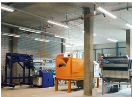
Bereich Verfahrenstechnik im neuen Labor. Von links nach rechts: Sensorsortierer (TiTech), Wirbelstromabscheider (Steinert), Anlage zur Sortierung nach geometrischer Form (Eigenbau).
