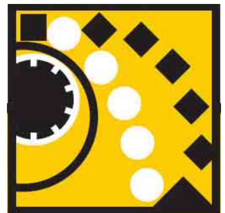
Trennung von elektrisch leitfähigen Materialien (schwarz) mittels Wirbelstrom
