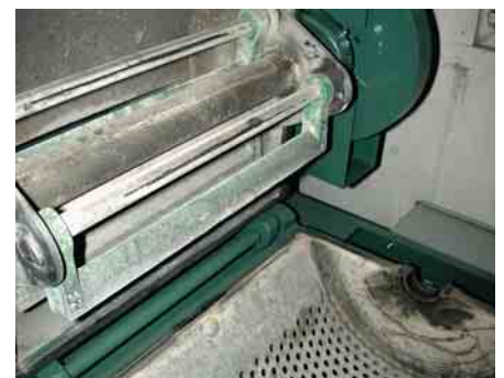
Schlagelemente und Siebtrommel der Hammermühle
