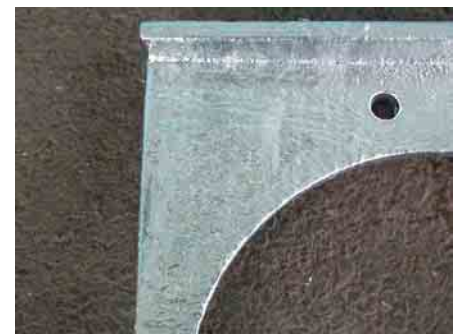
Überdicke Zinkschicht bei herkömmlicher Verzinkung.
