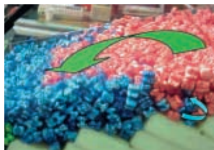
Abfalldurchmischung auf dem Verbrennungsrost.
