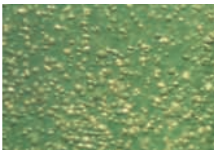
Das Blasenbild ist ein erster Hinweis zur Effizienz eines Belüfters.
