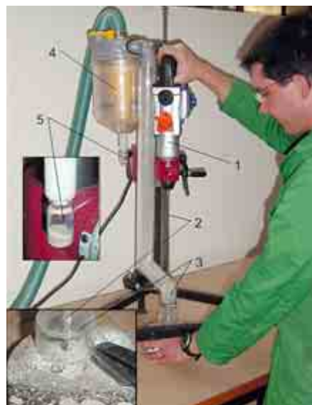
Probenahmeverrichtung: Bohrhämmer (1), Bohrer (2), Absaugvorrichtung (3), Zyklon (4), Probenglas (5)
