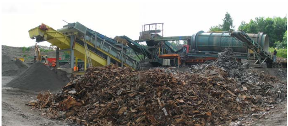
Rückgewinnung von Metallschrott aus den Verbrennungsrückständen einer KVA
