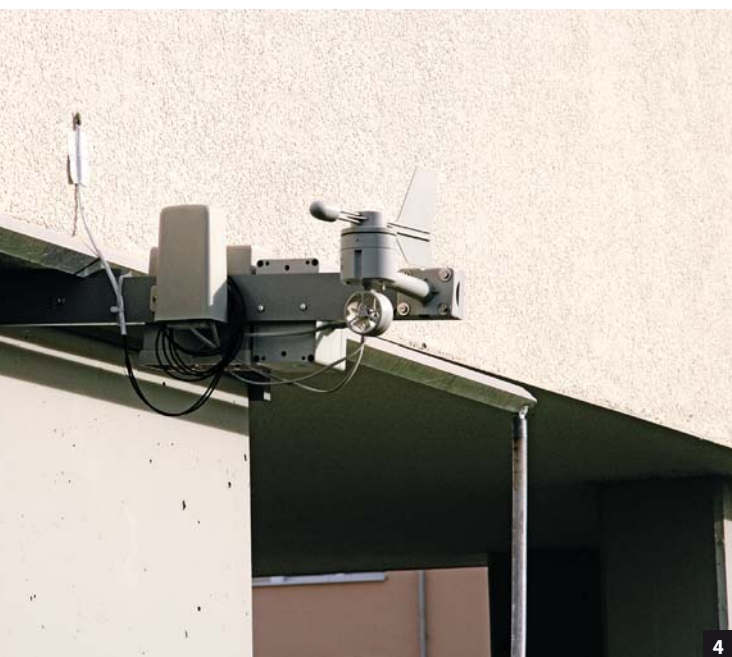
Abb. 4: Messeinrichtungen an gedämmten Fassaden zur Erfassung der Abflussmengen und der Biozidkonzentrationen. Die Abflussmengen sind generell gering und liegen bei Wohngebäuden im Bereich von < 1 % des Jahresniederschlags.
