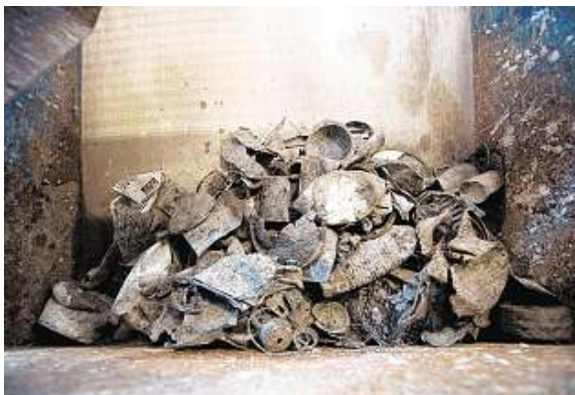
Feuerfest: In der Kehrichtverbrennungsanlage Trimmis werden Metallgegenstände aus der Schlacke zurückgewonnen.
