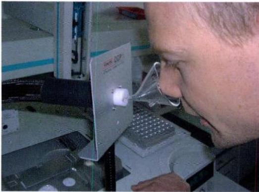
Abb. 5 Geruchsstoffanalyse am Sniff-Port.
