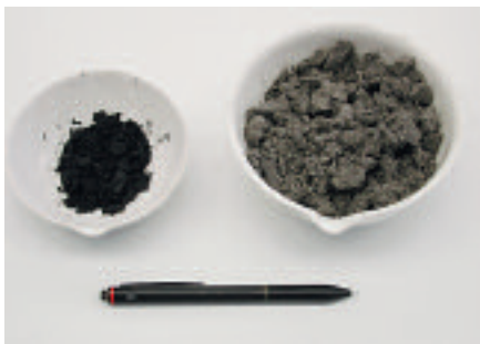
Mit Dioxin belasteter Russ (links) und gereinigte Filterasche.
