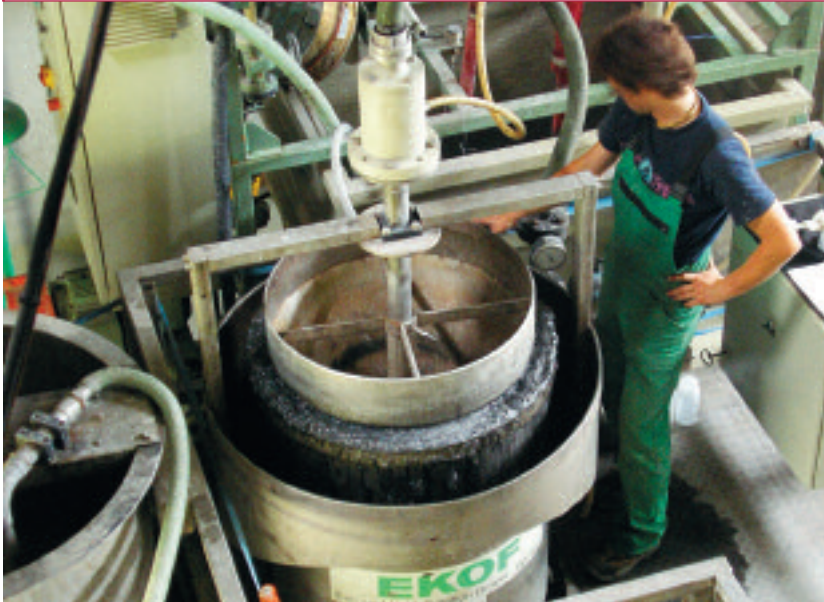
Pilotanlage zur mechanischen Trennung der dioxinhaltigen Russpartikel von der Filterasche aus KVA.
