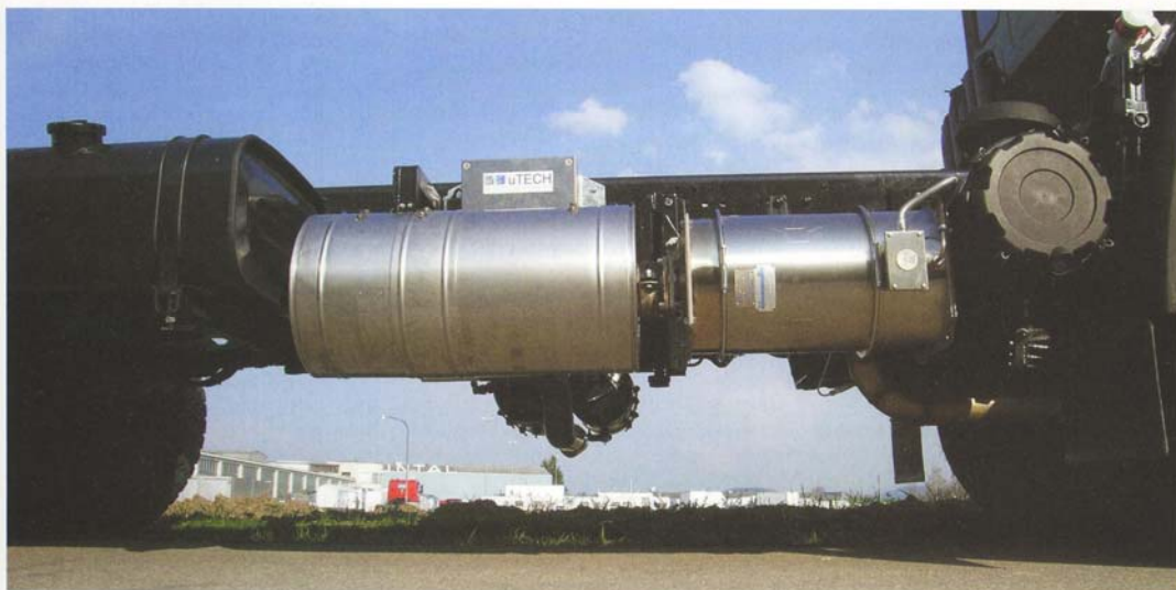
Ein neuer Lastwagen der Stadtgärtnerei Bern wurde mit Partikelfilter und dem SCR-Katalysator der Umtec Technologie AG ausgerüstet.
