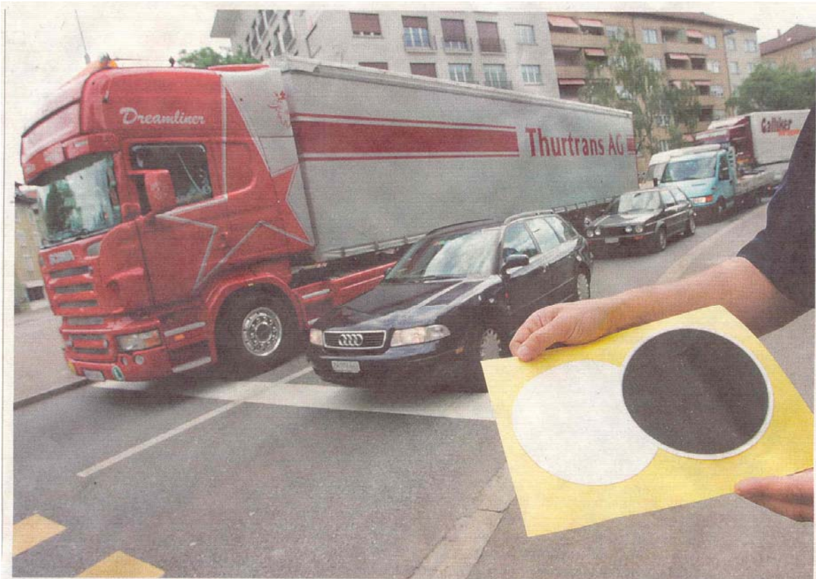
Abhilfe tut Not: Durch Feinstaub verschmutzter Filter an einer Zürcher Luftmessstation
