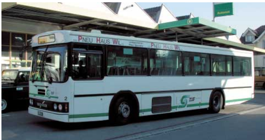
Das mit dem Abgasnachbehandlungssystem ausgerüstete Testfahrzeug erfüllt bereits die Norm Euro V und ist damit wohl der «sauberste» Dieselbus der Schweiz.
