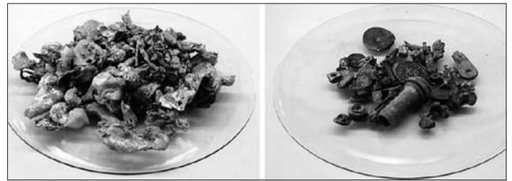
Abbildung 5: Aluminium-Nuggets (links) und Messingstücke (rechts) aus MVA-Schlacke (Trockenaustrag)
