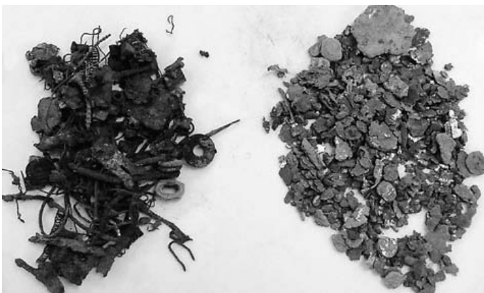
Abbildung 8: Die auf dem Sieb liegenden gebliebenen Metallstücke (flachgedrückt) werden mittels Magneten getrennt in eine magnetische Fraktion (links) und eine nicht magnetische Fraktion (rechts)
