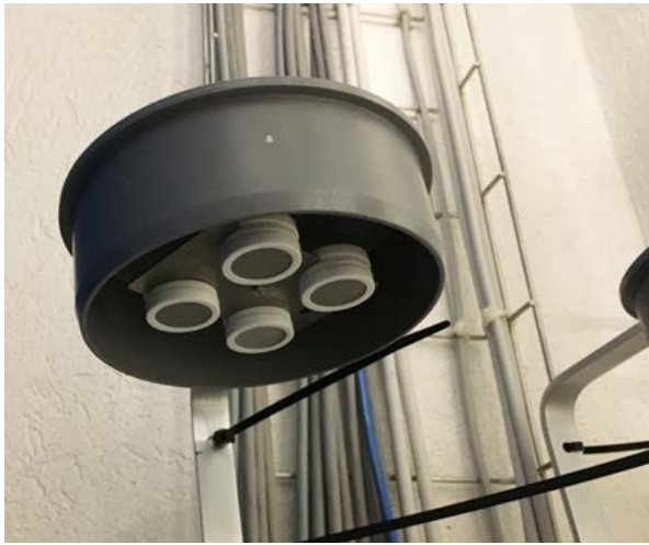
Abbildung 1: Erfassung der Schwefelwasserstoffkonzentration im KWKW mittels Passivsammlern.
