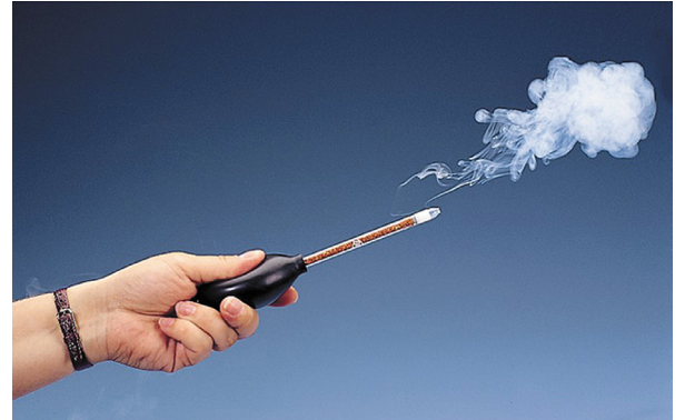
Visualisierung von Luftströmungen mittels Rauch
