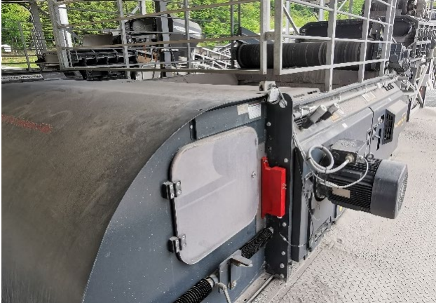
Abbildung 2: Blick auf den in der roten Staubschutzbox befindlichen "Sender" der Infrarot-Lichtschanke. Sender und Empfänger sind aussen am Wirbelstromscheider installiert und über zwei schmale Schlitz in der Gerätewand optisch miteinander verbunden.
