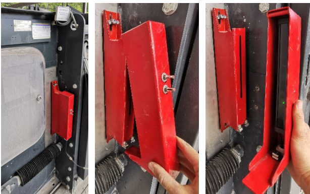
Abbildung 3: Blick auf die LED-Infrarot-Senderleiste in der geöffneten Staubschutzbox.
