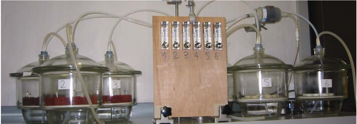
Abbildung 2: Emissionskammern (Exsikkatoren) mit den Proben Fensterkitt und Silikon
