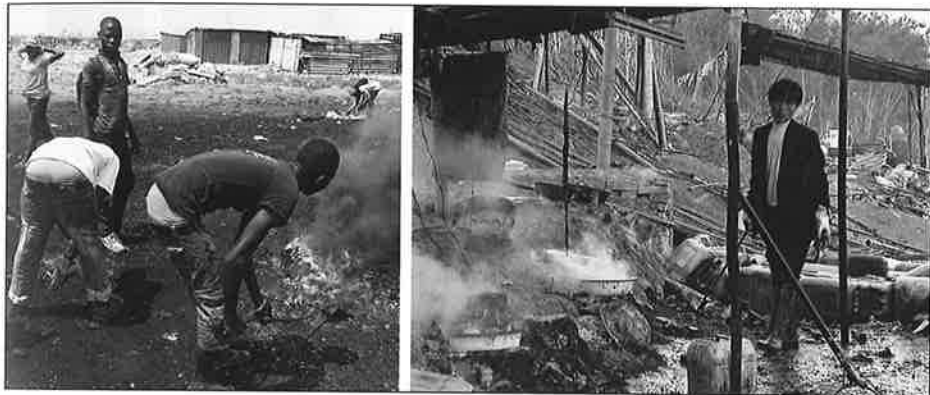
Abbildung 2: Elektroschrottreycling in Ghana (links): Zur Gewinnung von Kupfer wird die Isolation der Kabel abgebrannt; Elektroschrottreycling in China (rechts): Leiterplatten werden in Säuren ausgelaugt (Quellen: Foto links: Rainer Bunge; Foto rechts: Basel Action Network)
