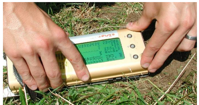
Abb. 3: Vor-Ort Analyse von Blei mit tragbarem XRF
