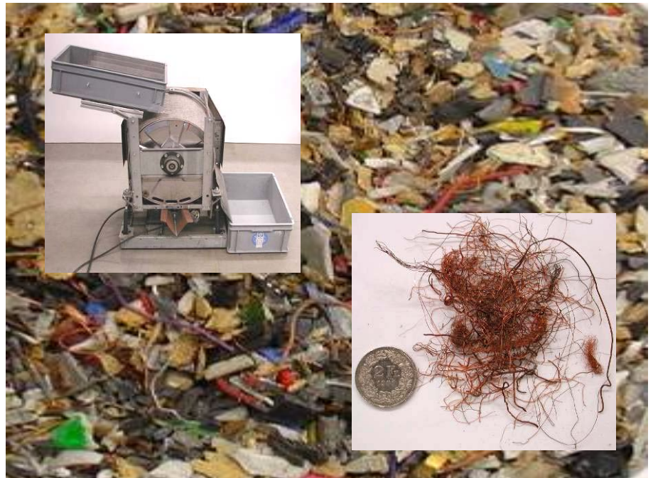
Abb. 1: Walzenseparator zur Abtrennung von Kupferdrähten aus RESH
