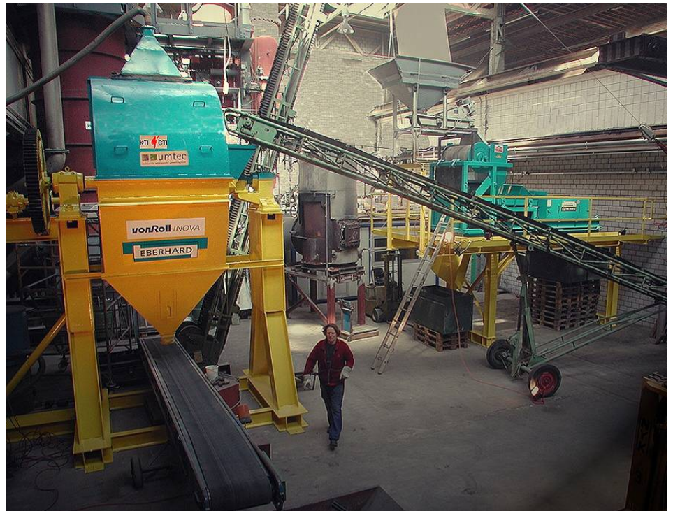
Abb. 1: Pilotanlage zur Schlackenaufbereitung: Betreiber UMTEC/vonRoll Inova/ERAG
