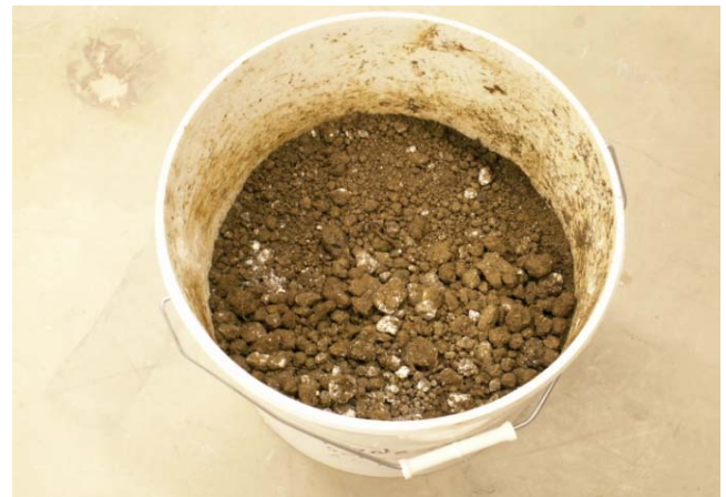
Abb. 5: Mit Löschkalk konditioniertes Bodenmaterial
