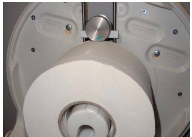
Abb. 4: Reibrad zur Messung des Papierverbrauchs
