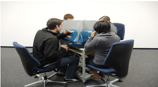
Abbildung 1: Geruchsmessung am Olfaktometer
