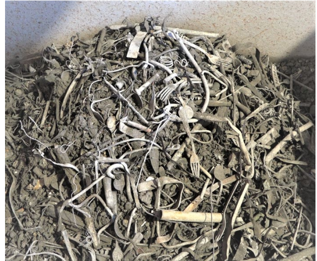
Abb. 5: Aus der Schlackenaufbereitung abgetrennte Langteile und Störstoffe.
