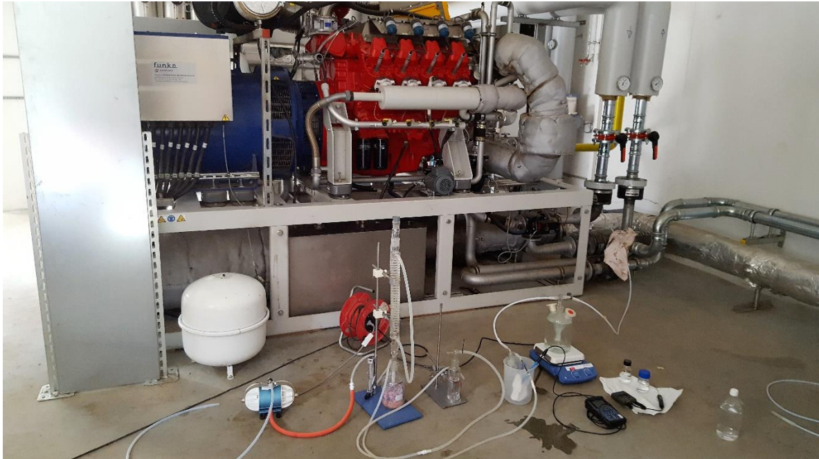
Versuchsaufbau der Waschstufensimulation. Ein Teil des Abgases wird aus dem Strom abgezweigt (rechte Seite) und in eine Wasserflasche geleitet.
